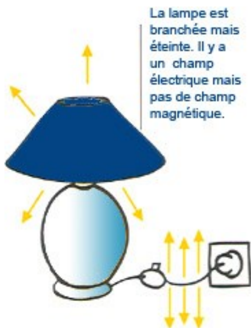
Figure 3 : la lampe est branchée, mais éteinte
